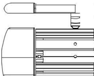
2. Fixer les retours et les angles sur le support, en laissant un espace de 2 mm entre le retour/angle et le support pour permettre un ajustement. Voir la figure 3.
