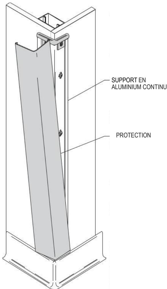
3. Placer le revêtement sur le support et ajuster le capuchon supérieur. En commençant par le haut, pousser le revêtement sur le support en appuyant sur toute la longueur jusqu'à ce qu'il se mette en place.
